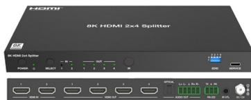
Le sélecteur/Distributeur HDMI Altimum SP24AUH2-8K dispose de deux entrées HDMI commutant et distribuant le signal vers quatre sorties HDMI de manière synchrone, avec une résolution vidéo allant jusqu'à 8K@60 4:2:0 12 bits.
