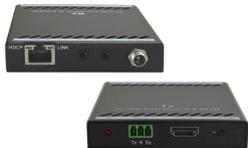
Le TP70SP est un ensemble d'extension HDBaseT composé d'un émetteur (TX) et d'un récepteur (RX). Il distribue le signal HDMI via un câble CAT.X à 70 m/PoC et permet le transfert IR et RS232 pour contrôler un périphérique source local depuis un écran distant.
